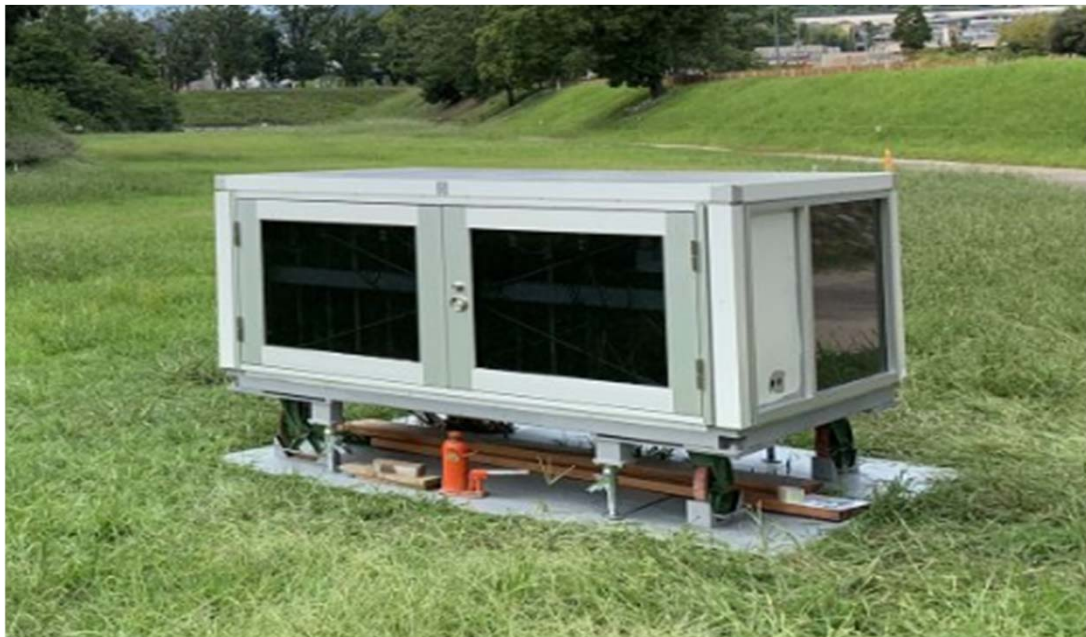
古墳の透視に利用されたミュオグラフィ測定装置 Muography detector used to view ancient tombs
