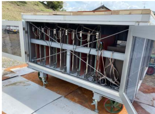
図5 装置の内部 (6枚の検知板と5枚の鉛板)
